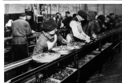
1913年、フォード・ハイランドパーク工場での発電機組立ライン
